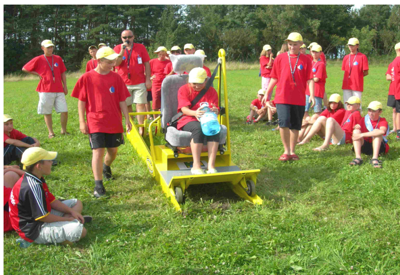
Fot. 4. Przyspieszenie działa również na osobę zajmującą miejsce w fotelu. Jak widać na fotografii, w momencie zatrzymania wózka uczestnicy testu nie mogą utrzymać na kolanach zbiornika z pięcioma litrami wody, pomimo, że czas, w którym opóźnienie przekracza 20g, w przypadku symulatora nie przekracza kilku milisekund.
