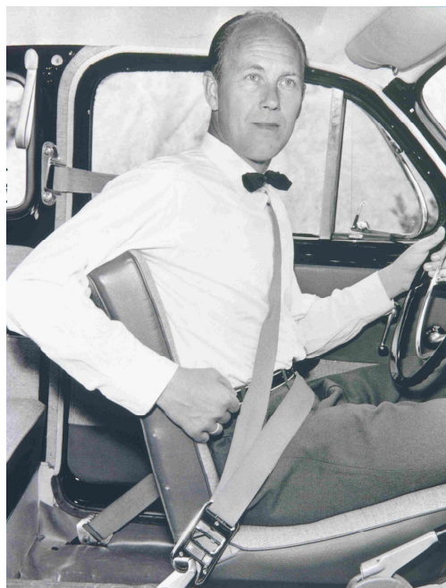
Fot. 1. Inżynier zakładów Volvo - Nils Bohlin, był wynalazcą pierwszych, trzypunktowych pasów bezpieczeństwa.
