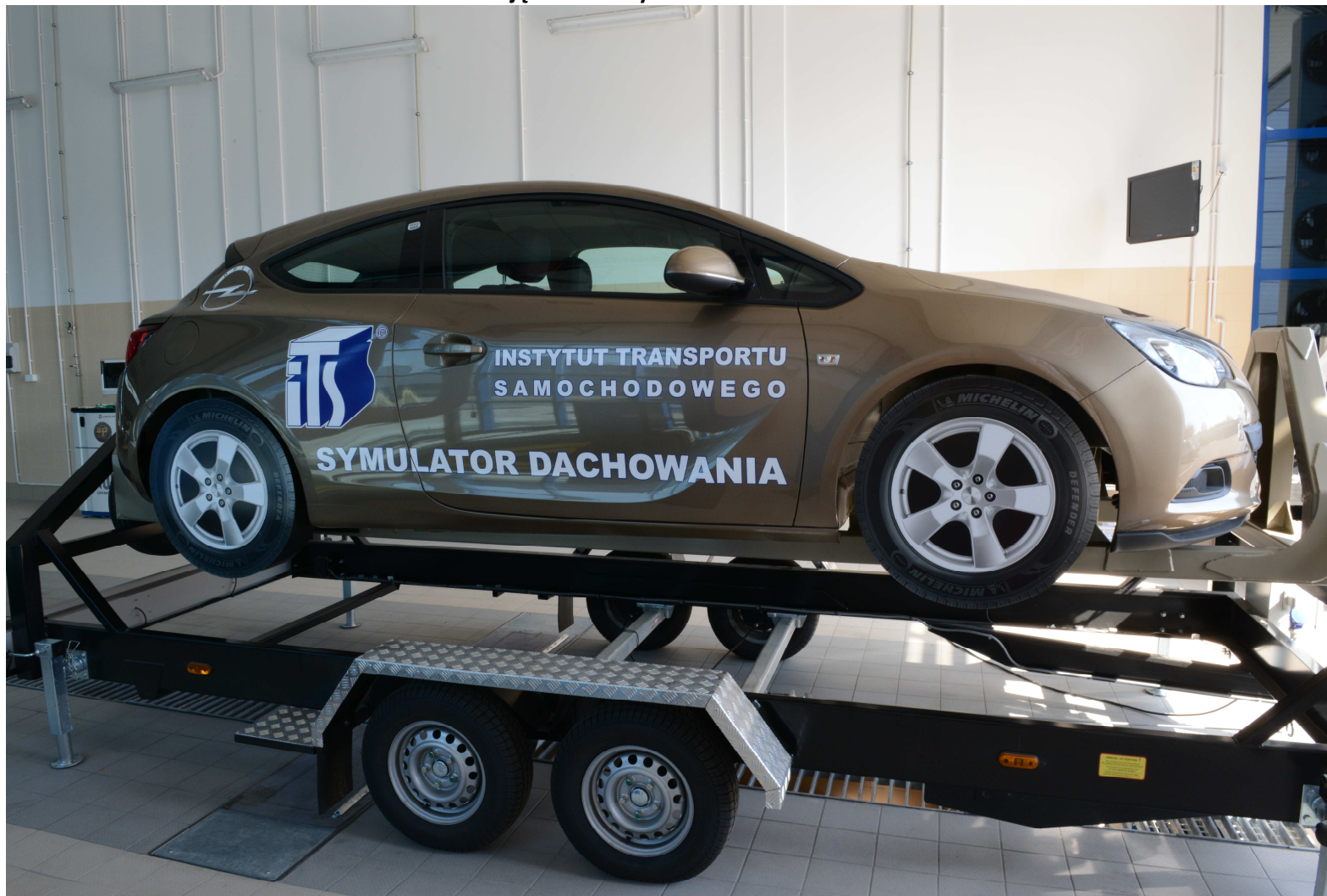
Zdjęcie nr 1 – symulator dachowania
