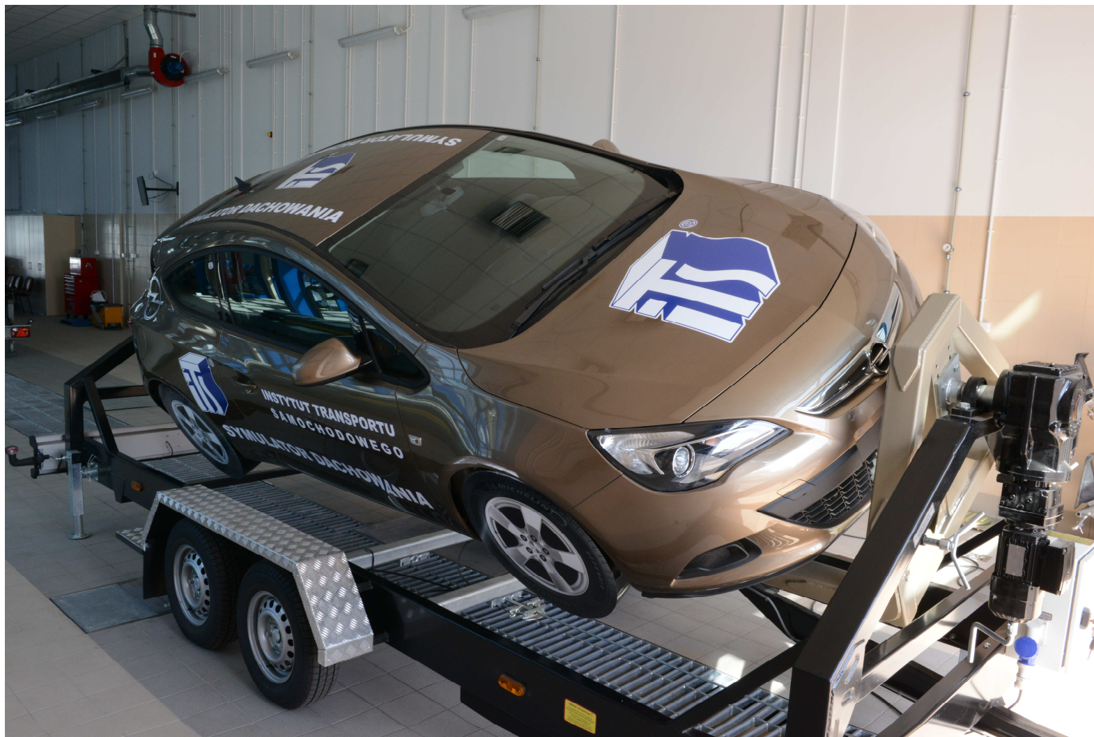
Zdjęcie nr 2 – symulator dachowania
