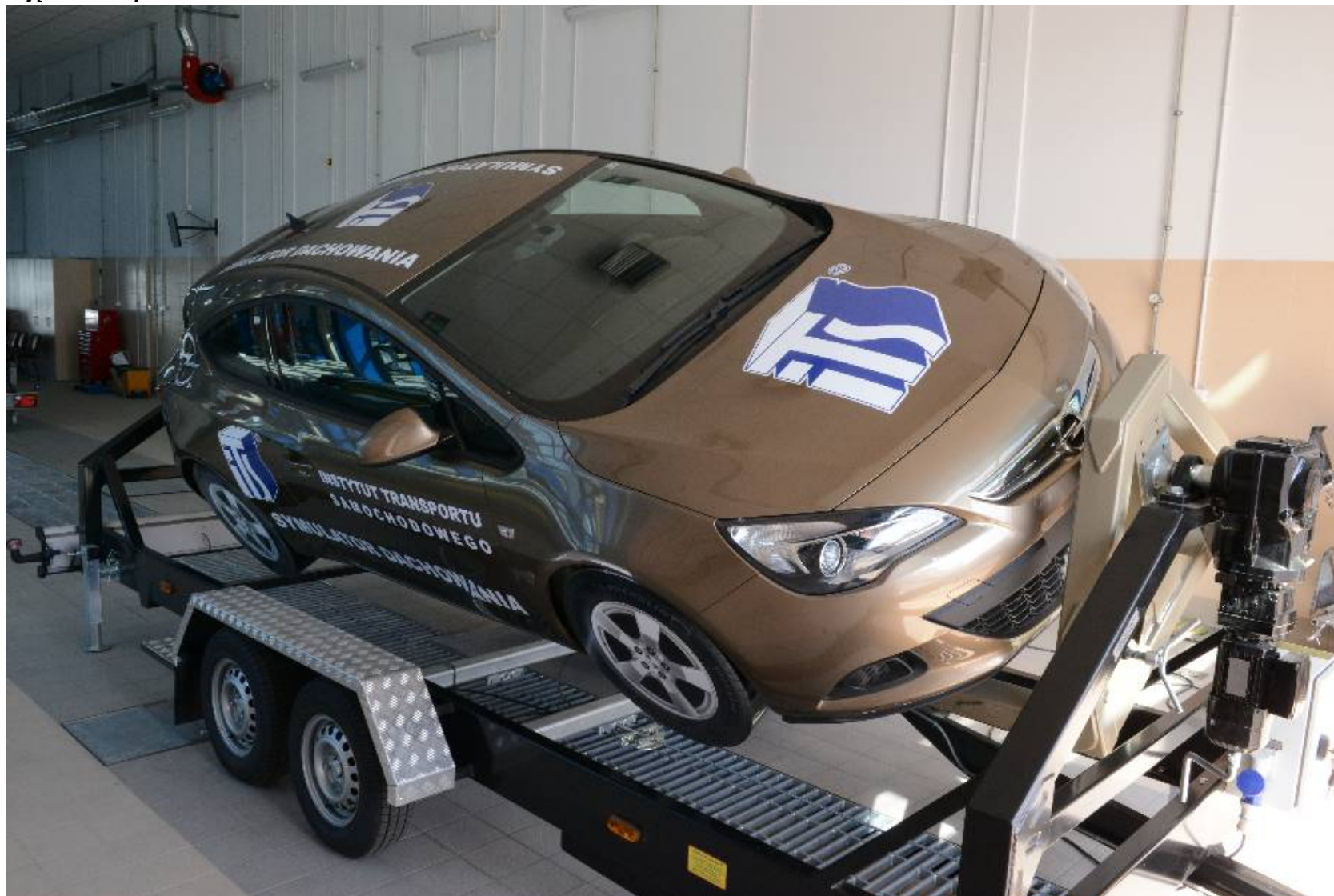
Zdjęcie nr 2 – symulator dachowania
