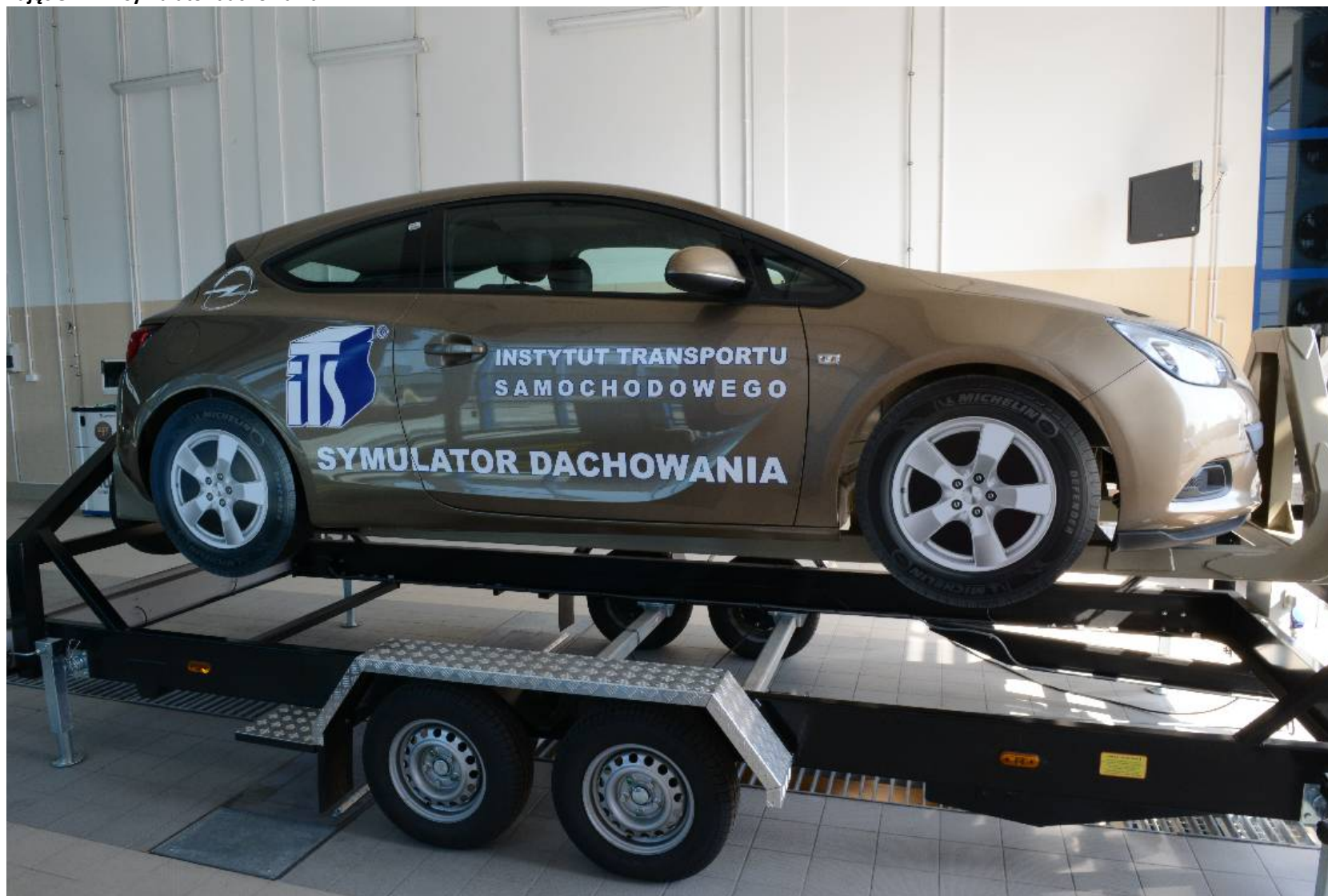
Zdjęcie nr 1 – symulator dachowania
